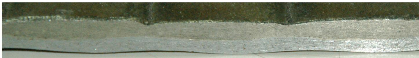
Acero Bimetálico resistencia a la abrasión extrema. Es una placa de acero S-235 (o aceros especiales bajo petición), revestida con soldadura con contenido de un 60% Tungsteno. Es una inversión rentable, que es aplicada en zonas de difícil remplazamiento y donde el coste de la parada o reemplazo, supera ampliamente la inversión en la placa de desgaste. Es el paso superior a las placas revestidas con carburo de cromo en cualquier variedad o composición.
