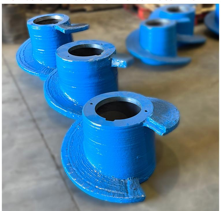
Construimos, recargamos y reparamos piezas sometidas al desgaste en **SuperPower® Tungsten**, como sinfines para industrias del cemento, madera, reciclaje, fundición, acerias, minería e industrias expuestas al manejo de sólidos abrasivos. Incidimos especialmente reforzando zonas sometidas a mayor abrasión, como la parte frontal mas externa de las espiras, alargando la vida util del equipo, disminuyendo paradas así como costes de mantenimiento.
